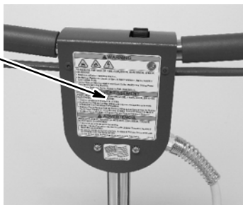
ÉTIQUETTE D'AVERTISSEMENT - (p/n 1072022) Apposée sur la partie arrière de la poignée de commande.
